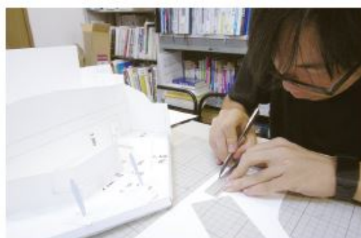
写真7 イメージを基に、実際に模型を製作し、スペーシングを確認する。これは紙製の模型の例。
